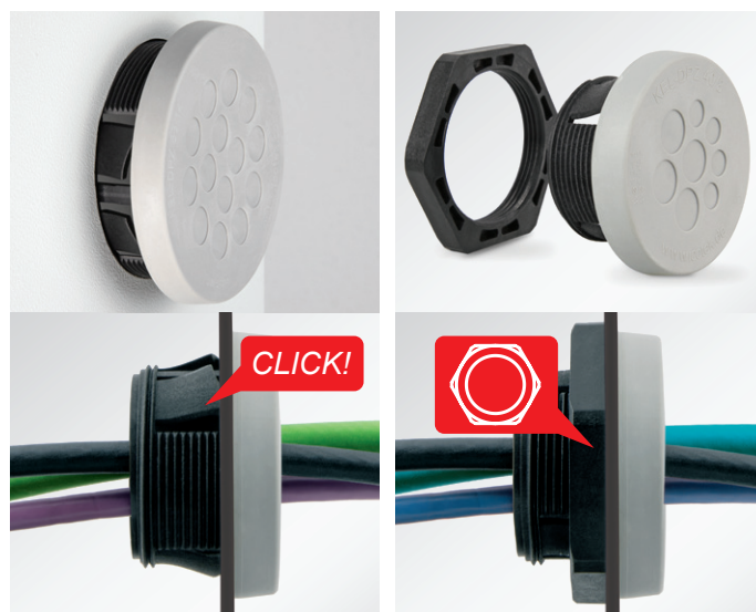
Montageart 1 Einrasten in den Ausbruch Für Wandstärken von 1 – 2,5 mm
