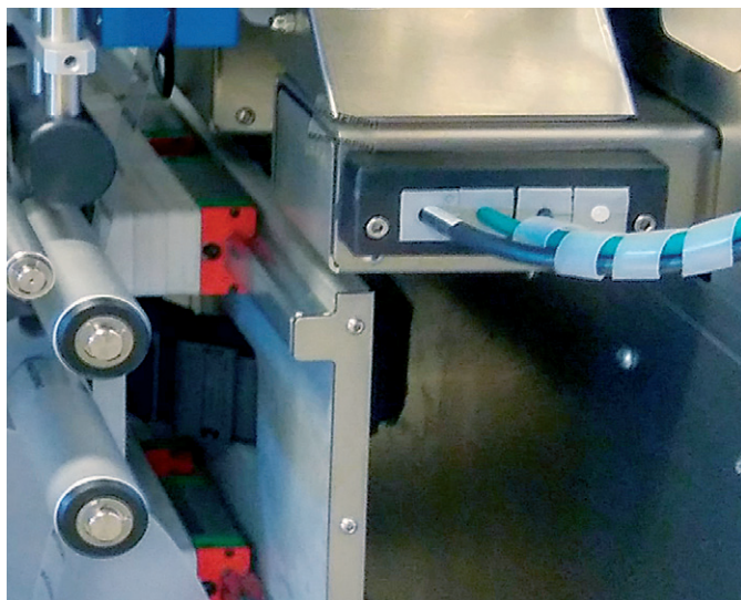
KEL-QUICK-E4 Bei dieser Anlage zur Inspektion und zum Bedrucken von Faltschachteln kommen zur Einführung in den Anlagenkörper KEL-QUICK-E4 Kabeleinführungsleisten zum Einsatz.
