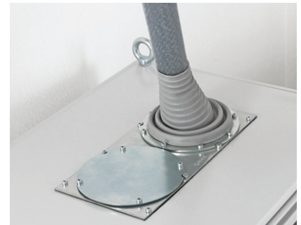
Einführung starrer Versorgungsleitungen mit Modulplatten durch das geschlossene Schaltschrankdach. Ausbruchgröße 314 x 144 mm
