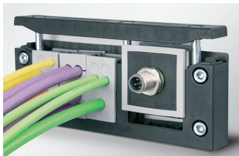
KEL-U 24/7 montiert mit 1x AT-M, bestückt mit 1 Steckverbinder M12x1,0, für den Anschluss von Sensoren.
