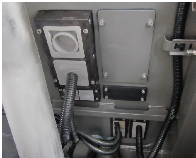
KEL-JUMBO 2 / KEL 24|x Einführung von Wellschläuchen und Leitungen im Fahrzeugrahmen.
